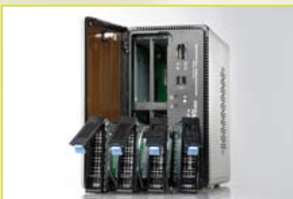
Hot Swap: einfachstes Wechseln von Festplatten im Betrieb
